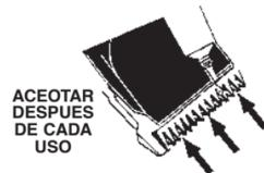
1. Coloque unas cuantas gotas de aceite Wahl entre los dientes de las hojas de su cortadora antes y después de cada uso. El aceite debe aplicarse mientras la cortadora esté funcionando. Después de cortar cabello mojado, limpie las hojas y aplique unas gotas de aceite Wahl. Utilice SOLAMENTE el aceite Wahl.
