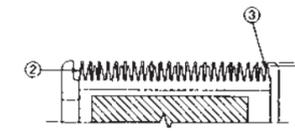
La dent complètement à gauche de la lame supérieure doit couvrir la première petite dent de la lame inférieure ou se trouver à sa gauche. La dent complètement à droite de la lame supérieure doit toucher la grosse dent de la lame inférieure de la hoja inferior.
